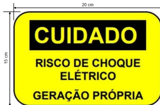
Figura 1 - Placa de Advertência de Geração Distribuída
